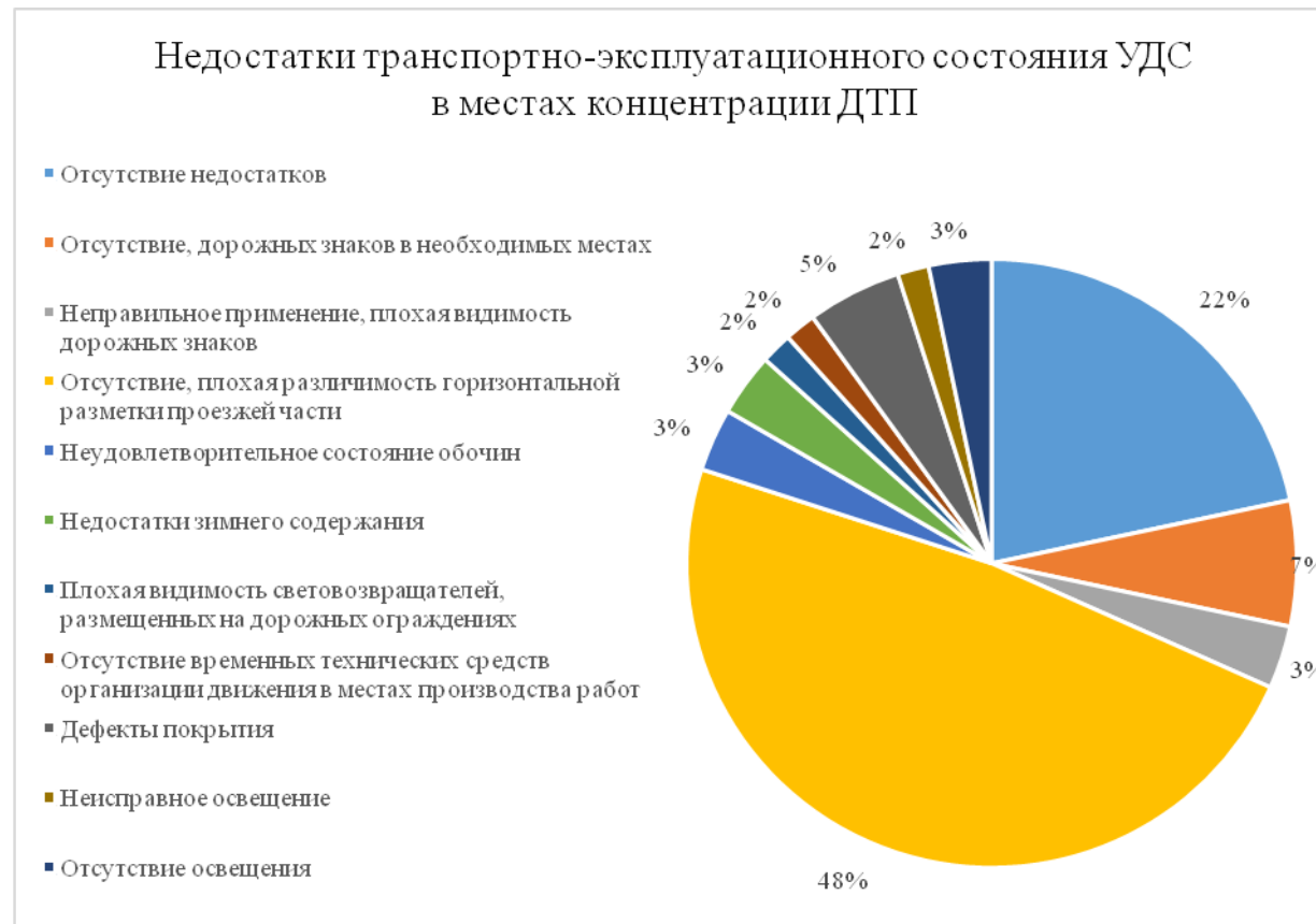
Рис. 10 – распределение выявленных недостатков транспортно-эксплуатационного состояния УДС
