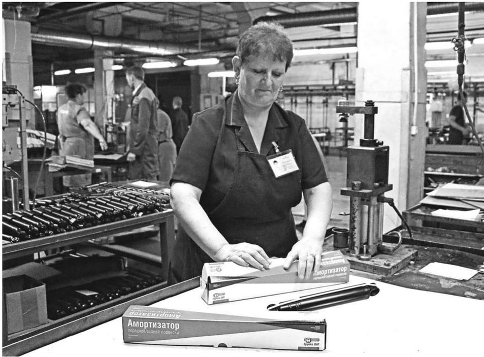
Линия производства штоков для амортизации задней подвески
