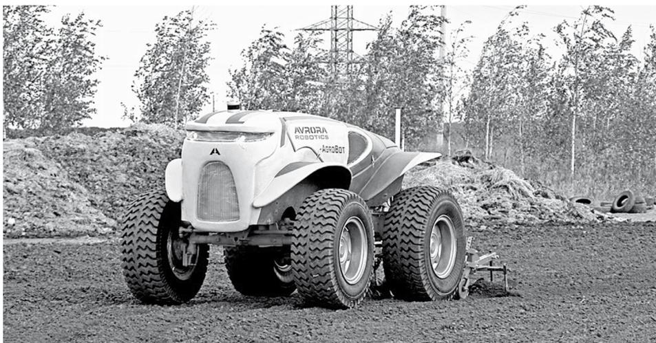
«Агробот» – беспилотный трактор компании Aurora Robotics, который в автоматическом режиме может проводить обработку почвы, внесение удобрений, посадку культур, полив, покос и сбор урожая, транспортировку собранной с/х продукции
