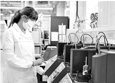
Лаборант выполняет испытание дизельного топлива по определению предельной температуры фильтруемости
