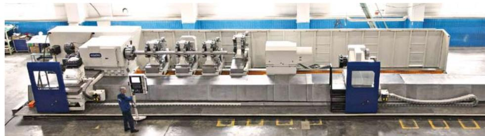
Тяжелый токарный станок для «Роскосмоса» спроектированный и созданный ПАО «Саста». Общая длина станка – 25 метров, а вес 120 тонн. Максимальная масса заготовки для обработки – 60 тонн
