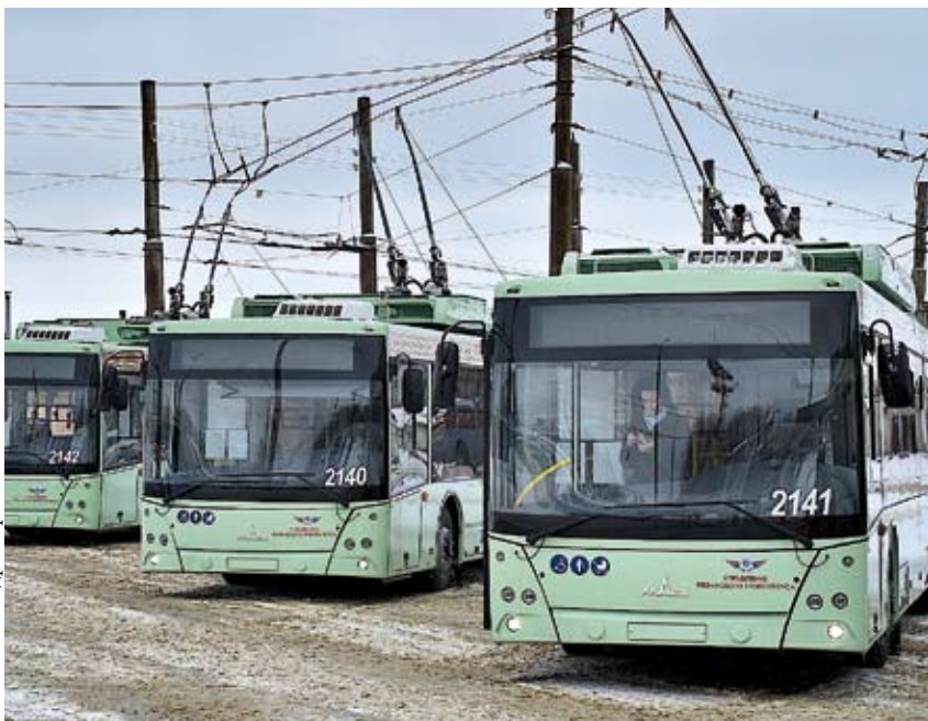
Все новые троллейбусы оборудованы возможностью автономного хода, это позволит продлить существующие маршруты в новые районы города Рязани без удлиннения контактной сети
