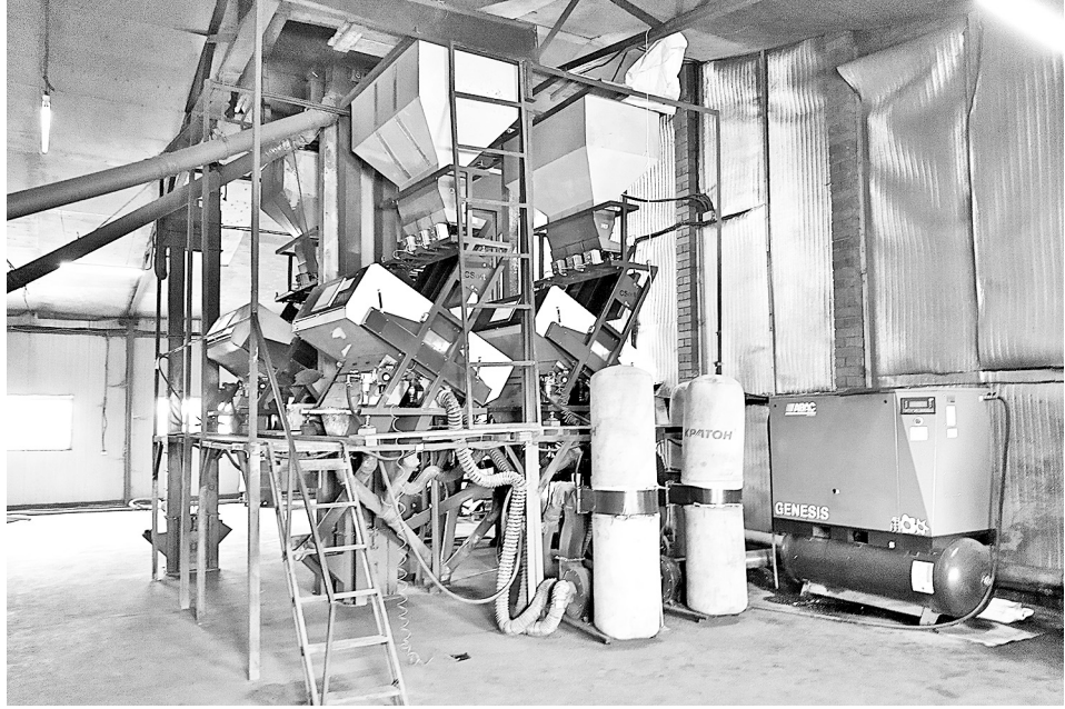
Фотосепаратор обеспечивает контроль каждого зернышка из триллионов в партии
